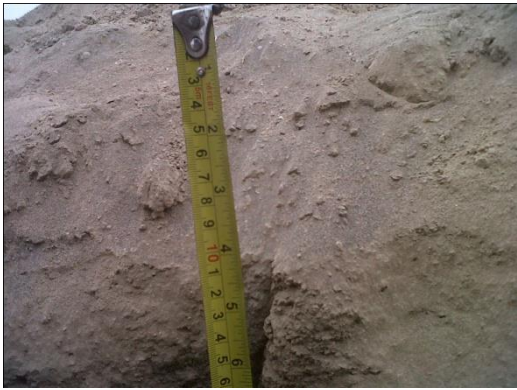
20 a 60cm de profundidad) arcilla muy dura y difícil penetrar.
